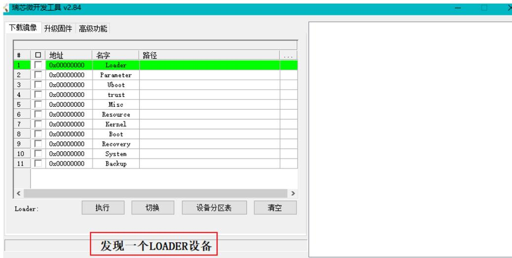
14. 在 RK 开发工具窗口，依次点击**升级固件** > **固件**；
