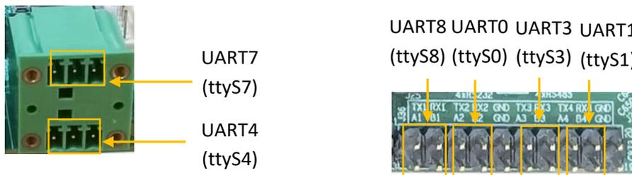
用户可以使用合适的 USB 转串口适配器连接主板的串口和主控电脑（RS232 接线：TX-RX, RX-TX, GND-GND; RS485 接线：A-A, B-B, GND-GND），然后在主控电脑上使用串口工具进行串口通信，测试串口功能是否正常。
