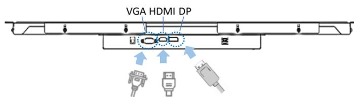
注意：仅 21.5"及以上尺寸的触控显示器提供 DP 接口。DP 显示线为选配件，可能不会包含在产品包装内。请根据显示接口类型选择连接的显示线。有时，或需要使用转接线进行连接。
