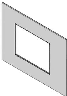
2. 确保开口上的螺丝孔与触控显示器侧面安装支架上的螺丝孔对齐；
