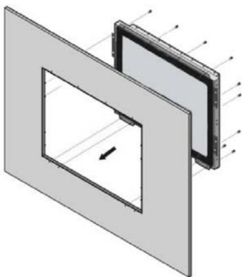
3. 使用电动螺丝刀紧固螺丝。
