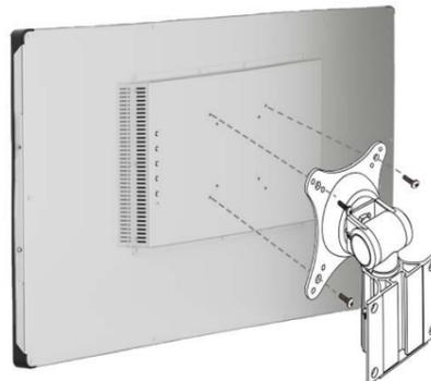
2. 使用电动螺丝刀紧固螺丝。
