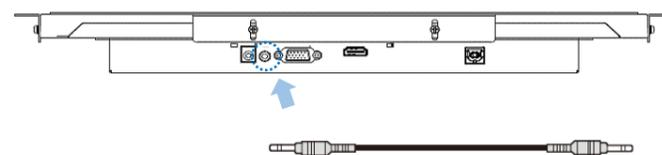
注意：音频输入接口以及两个内置喇叭根据客户需求提供，并非 TMO 系列所有触控显示器均会提供。
