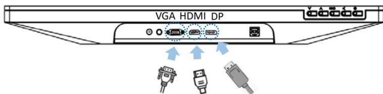
**注意：**仅 21.5" 及以上尺寸的触控显示器提供 DP 接口。请根据显示接口类型选择连接的显示线。有时，或需要使用转接线进行连接。
