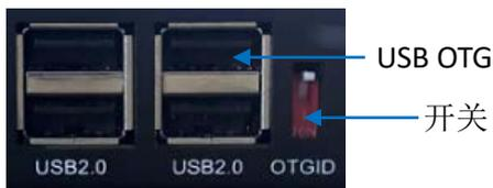
在将设备连接至主机进行应用安装或镜像烧写之前, 请确保已经将 USB OTG 切换到设备模式。
