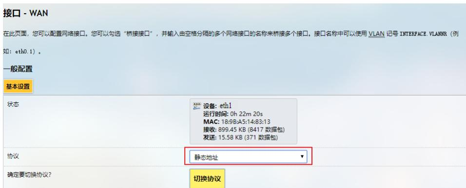
点击**切换协议**后，需要输入 IPv4 地址、子网掩码、IPv4 网关，以及 IPv4 广播。还需要添加自定义的 DNS 服务器。
